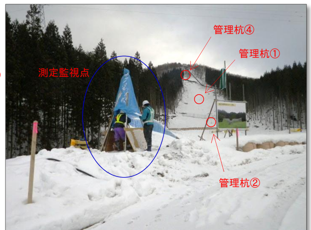
崩壊斜面の測定監視状況
