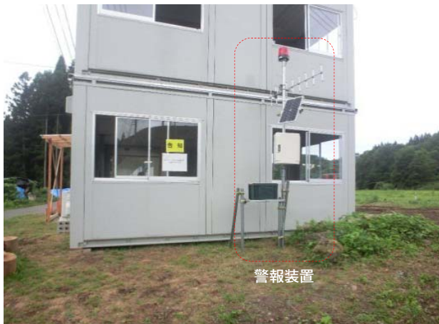
ワイヤーセンサーと連動した警報装置
