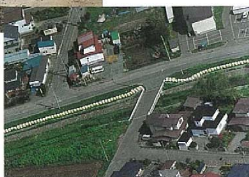
板谷川沿いに設置された大型土のう (5/21撮影)
