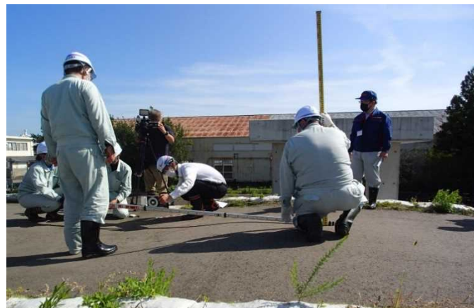
堤防の抜け上がり計測の実習
