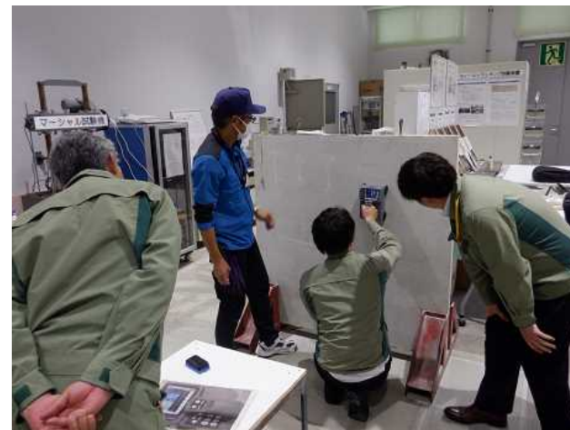
非破壊検査(鉄筋探査)体験
