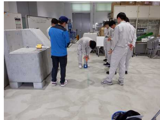
非破壊検査(テストハンマー)体験
