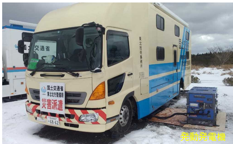
現地到着後、待機支援車が利用できるように発動発電機を設置
