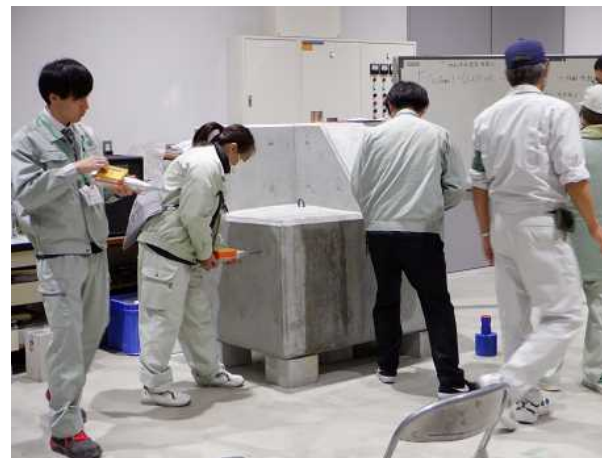
非破壊式コンクリート強度試験
