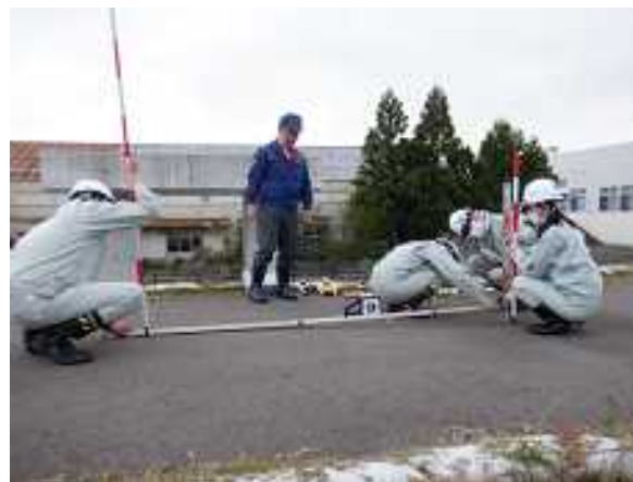
堤防の抜け上がりの計測
