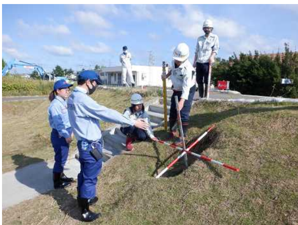
堤防の陥没の計測
