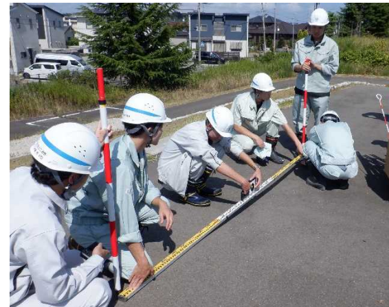
堤防の抜け上がりの計測
