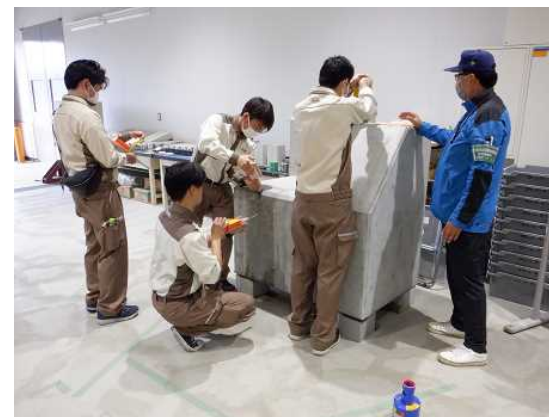
非破壊検査(テストハンマー)体験
