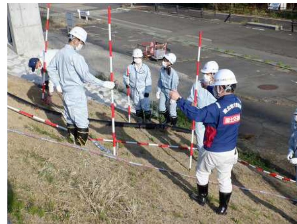
堤防のはらみ出しの計測
