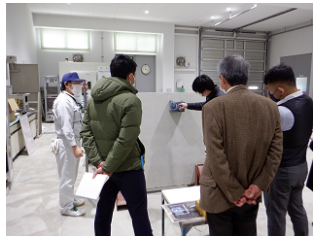
非破壊検査(鉄筋探査)体験
