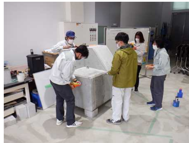
非破壊検査(テストハンマー)体験
