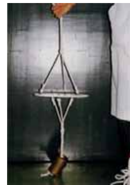
図 - 9 透明度板 おもりに採水器のメッセンジャーを使用
