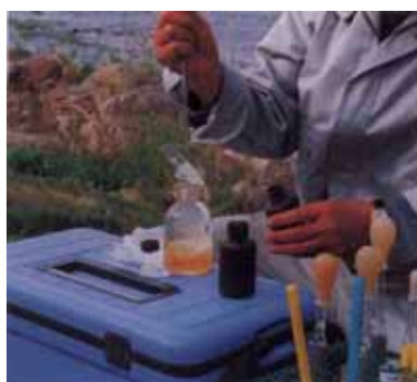
. アルカリ性ヨ化カリウム-アジ化ナトリウム溶液添加
