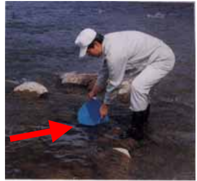
バケツでの採水 橋から採水する場合は ロープ等を用いてもよい。
