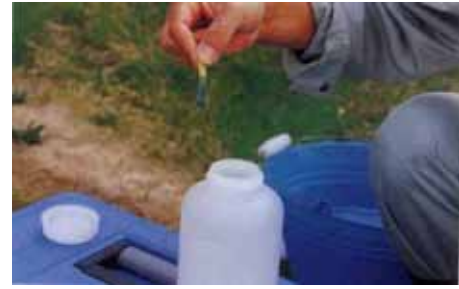
試薬添加後、pH 試験紙で固定状況確認 試験紙の色が試水に混ざらないように素早く確認
