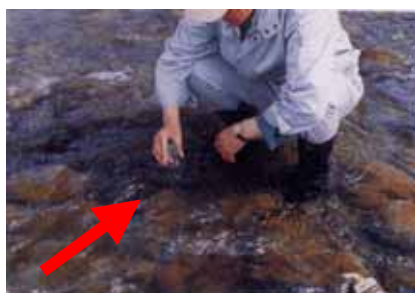
図 - 12 DO 瓶に直接採取
