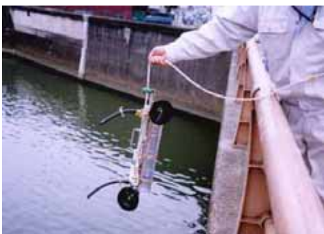
バンドーン採水器での採水
