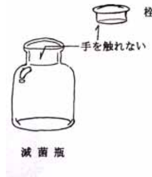
図 - 17 滅菌瓶による採水
