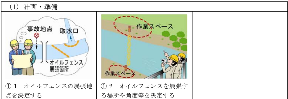
図 3.7 (1) オイルフェンスの展張手順
