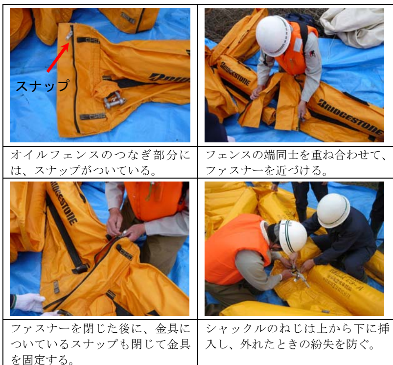
図 3.12 オイルフェンスの接続の様子
