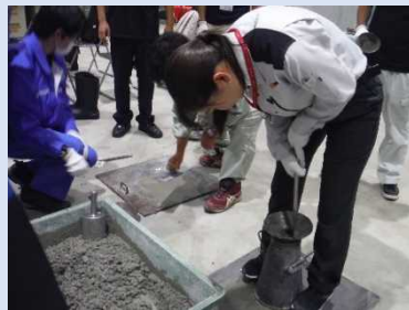
実習：生コンスランプ試験
