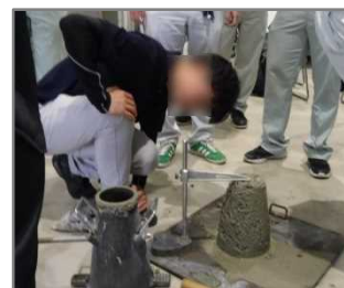
実習：生コンスランプ試験
