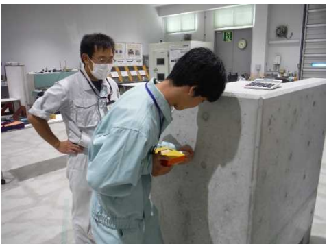
▲ 非破壊試験実習 （テストハンマーによる強度推定）
