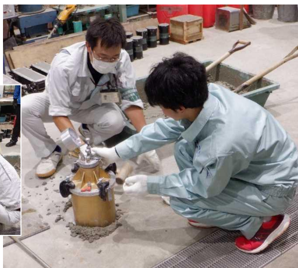
▲ コンクリート材料試験実習（左：スランプ 右：空気量の測定）
