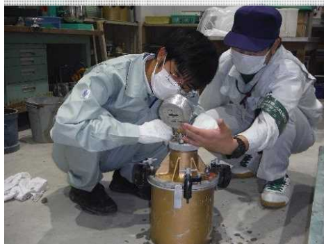
材料試験実習（コンクリート・空気量測定）
