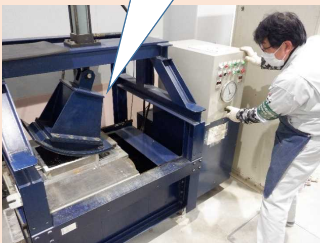
ホイールトラッキング試験用供試体作製状況
