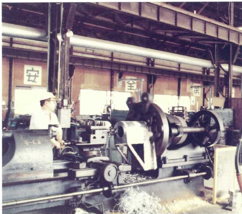
写真-③ 稼働中の6尺（全長約2m）旋盤
