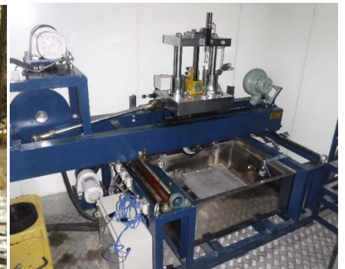
【ホイールトラッキング試験機】 わだちによる変形に対する抵抗性を確認する試験機
