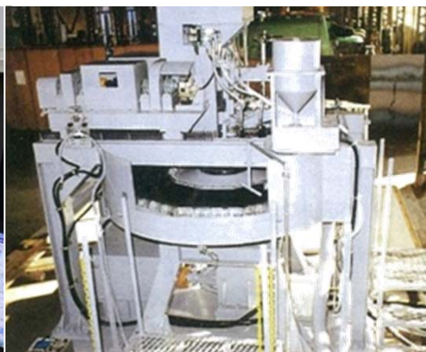
【スパイクラベリング試験機】 スパイクタイヤに対する抵抗性を確認する試験機
