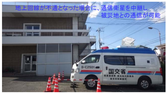
【衛星通信車(福島県鏡石町役場)】
