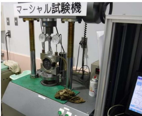
【マーシャル安定度試験機】 石、砂、粉、アスファルトの混ぜる割合を確認する試験機
