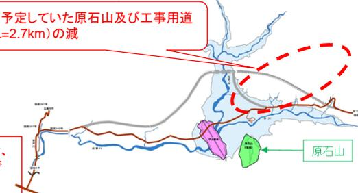
台形CSGダムは、周辺から採取できる砂礫を活用でき、ダム堤体の体積も少なくなるため、1箇所からの採取で必要量を確保する計画。
