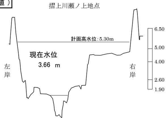
※計画高水位は、河川を整備する上での基本となる水位で、計画の洪水を流すことができる最高の水位です。
