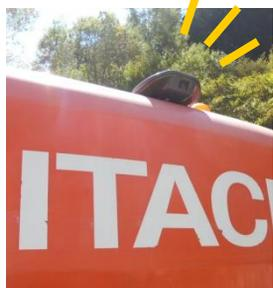
重機にバックモニターがある。 低毒素油処理剤が常備されている。
