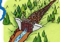
③大雨が降り土石流が発生した時、大きな岩、流木などを含む土砂は、堰堤にひっかりり止まります。
