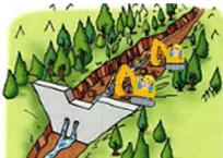
④堰堤にたまった岩、土砂や流木は、次の土石流に備えて取り除きます。
