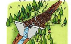
③大雨が降り土石流が発生した時、大きな岩、流木などを含む土砂のため、下流への被害を防ぎます。
