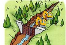
④堰堤にたまった岩、土砂や流木は、次の土石流に備えて取り除きます。
