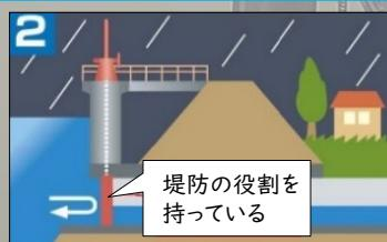
洪水により川の水位が高くなると、川の水が樋門・樋管を通して住宅側に流れ込み(逆流)、浸水被害が発生するため、樋門・樋管の扉を閉めます。
