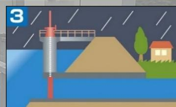
樋門・樋管の扉を閉めると、住宅地の水の行き場がなくなり、住宅地が浸水する場合があります。そのため内水被害が発生する場合には**排水機場設置**や、**排水ポンプ車**で排水するなどの対策を講じています。
