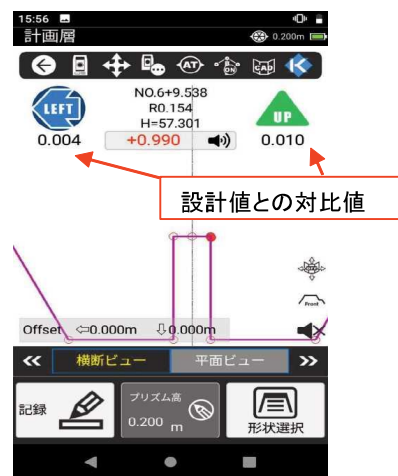
快速ナビ出来形観測状況
