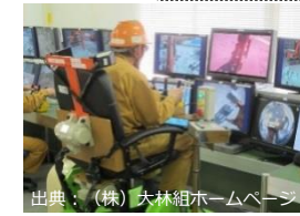
体感装置付運転席を用いた現実に近い操作の実現
