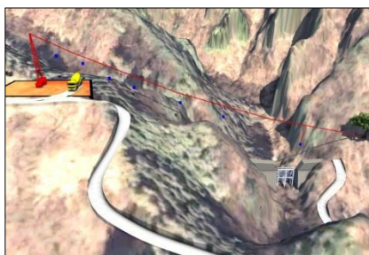
施工性確認（バケット軌跡）
