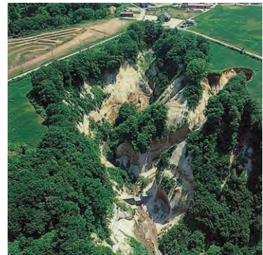
写真 10-2 地すべりによる土砂生産（湯の台大曲沢） 肘折カルデラのすぐ下流にある湯の台地区では、地すべりやがけ崩れでむかしからさかんに土砂がつくられてきました。
