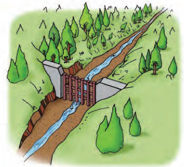
透過型砂防堰堤は、ふだん少しずつ流れてくる土砂は、堰堤のすき間から下流に流す。
