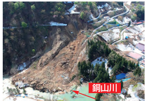
写真 24-3 平成 24 年 4 月に肘折地区で発生した地すべり性の斜面崩壊 銅山川が一時、土砂でせき止められ、肘折温泉が浸水するおそれもありました。
