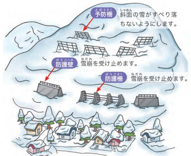
図 37-2 雪崩災害を防ぐ施設
