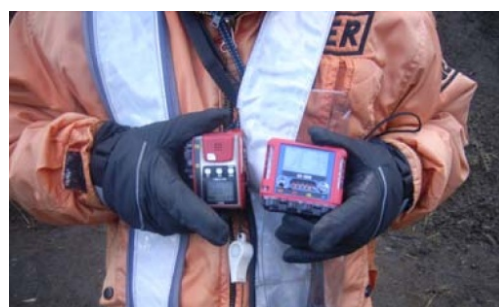
霧島山(新燃岳)噴火時に現場代理人が携帯したガス検知器
