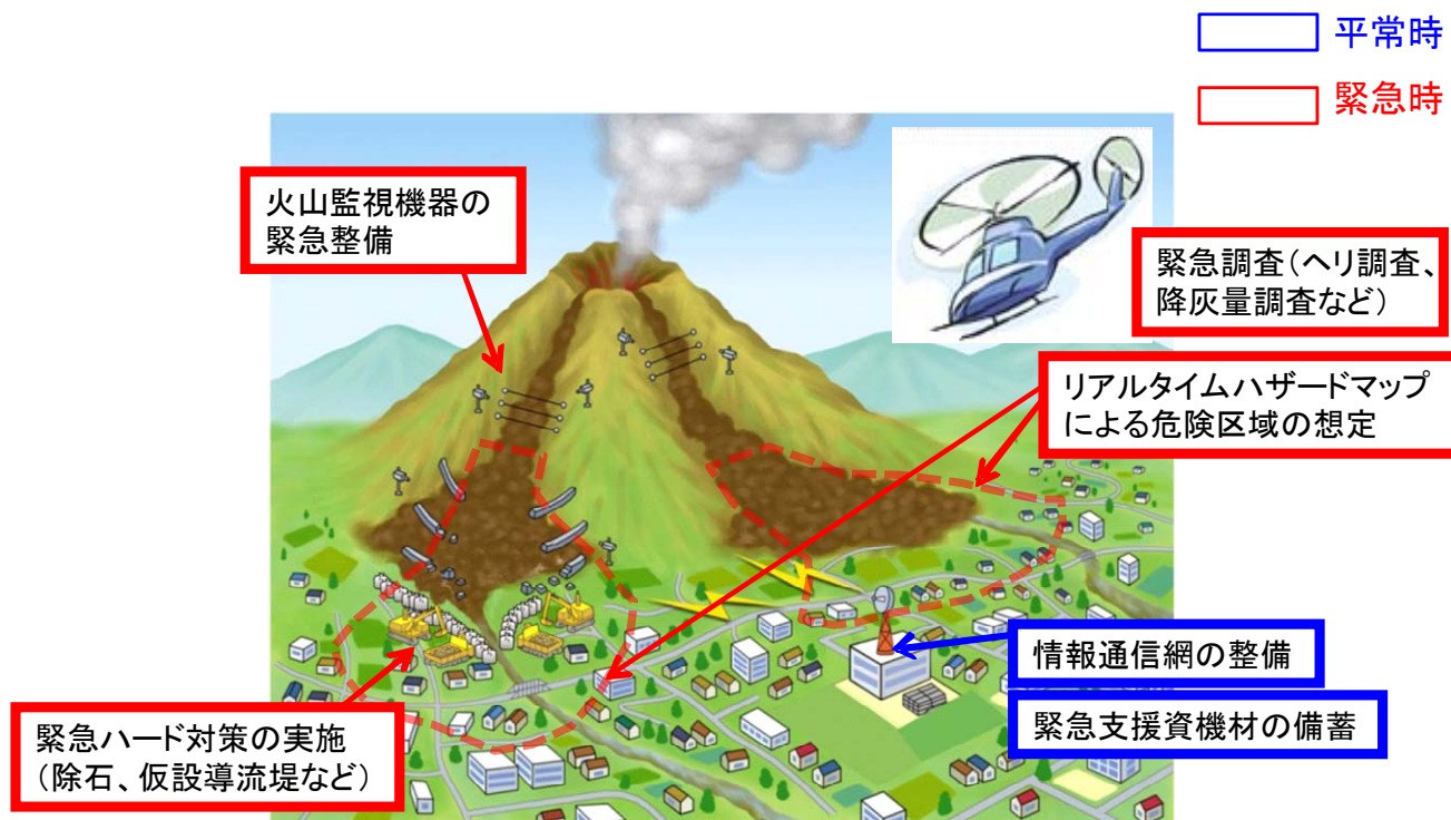
図 1-3 火山噴火緊急減災対策砂防計画のイメージ
