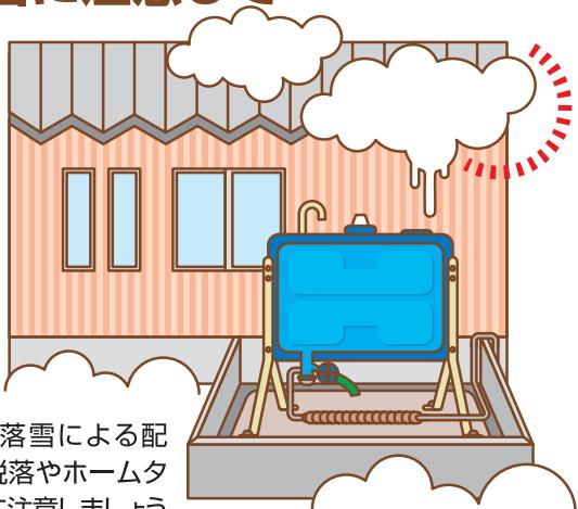
屋根からの落雪による配管の破損・脱落やホームタンクの転倒に注意しましょう。
