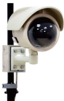
設置した簡易型河川監視カメラ
