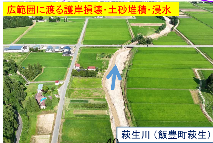
護岸損壊(120m)、市道橋流失
