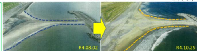
養浜施工前と施工後のヘッドランド比較写真(写真2、3)
