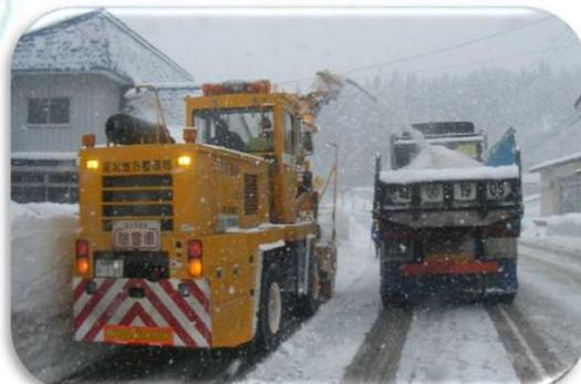
建物が密集した人通りもある市街地などの路肩部分に堆積した雪をロータリ除雪車などでダンプトラックに積み運搬する作業を行います。
