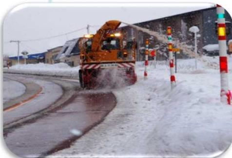
ロータリ除雪車で、道路脇に寄せられた雪壁を飛ばして道路の幅を広げる作業を行っています。
