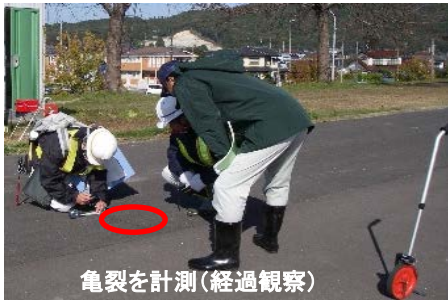
天端舗装上の亀裂を計測(経過観察)
