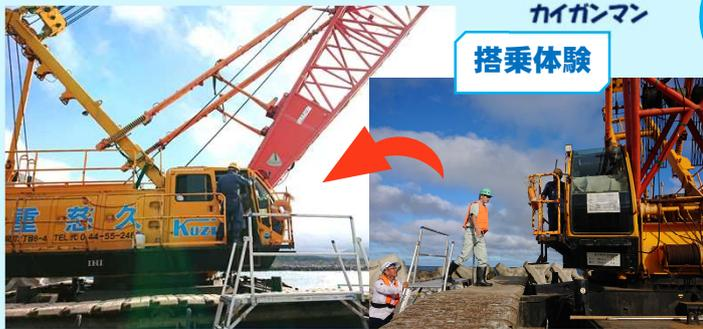
このクレーンで、ヘッドランドに16t型消波ブロックを設置しているのよ！
