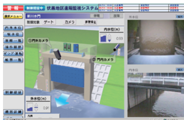
図 5-34 河川管理施設の遠隔監視システム
