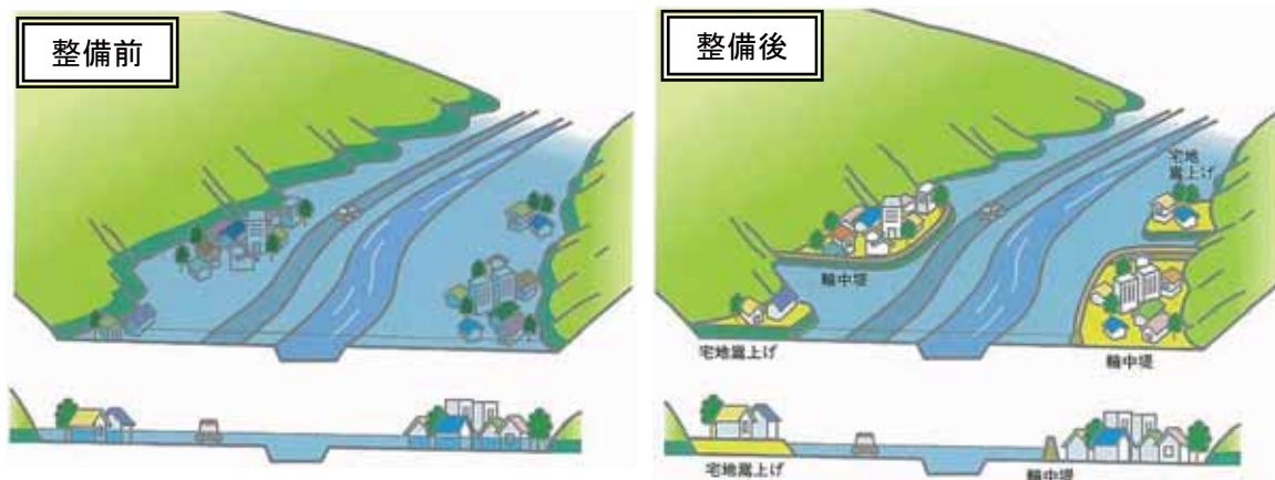
図 5-9 氾濫及び地形特性に応じた治水対策 イメージ図
