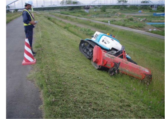
大型遠隔式除草機械による除草状況
