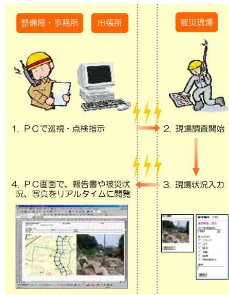
図 5-28 河川巡視点検システムのイメージ
