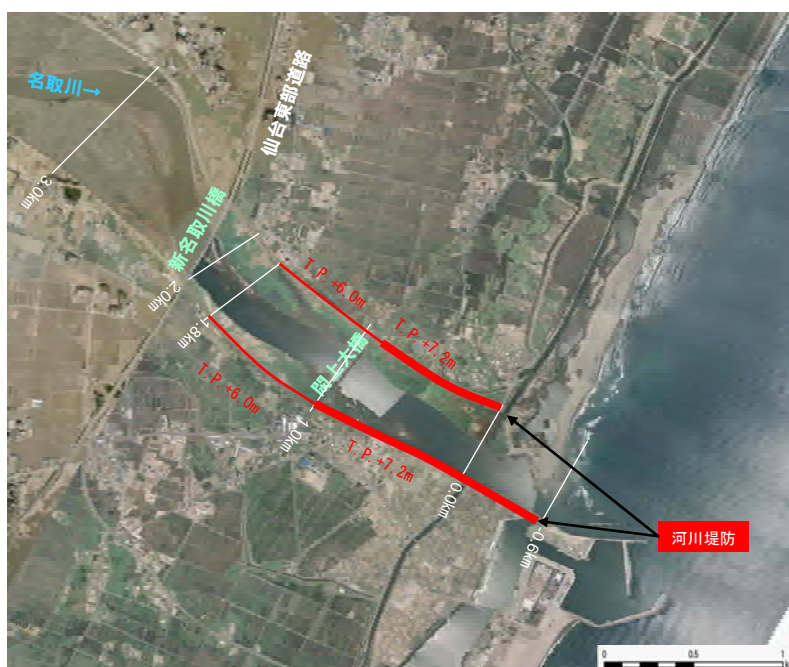
河口部の堤防縦断イメージ
