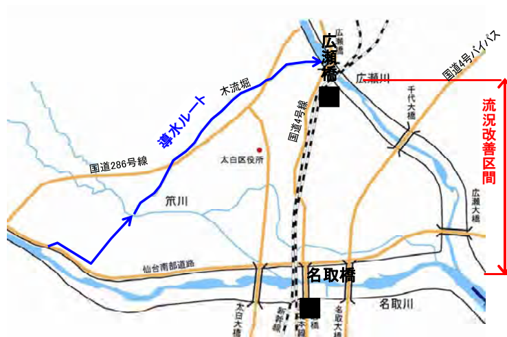
図 5-15 広瀬川への導水
