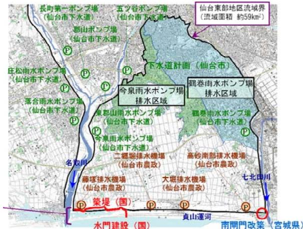
図 5-9 内水対策の取り組み状況(地震前)
