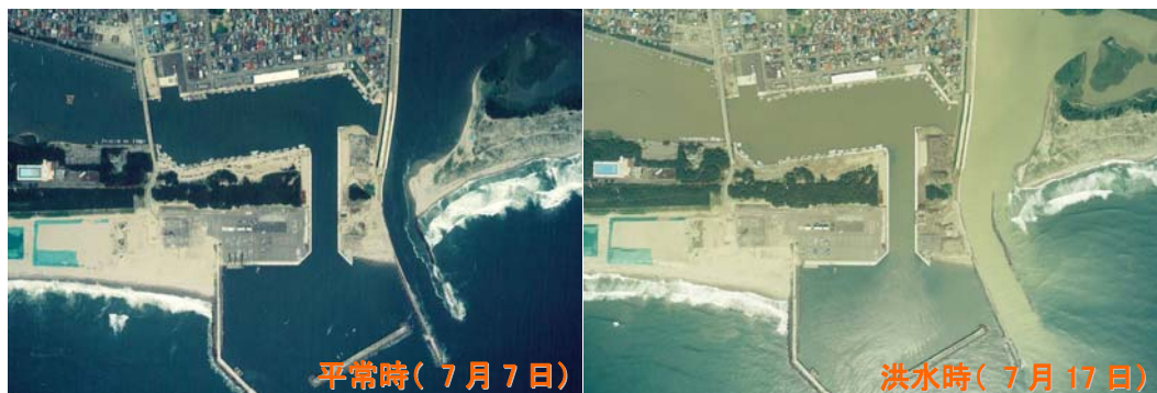
図 5-19 平成 14 年 7 月洪水時の河口砂州の変化
