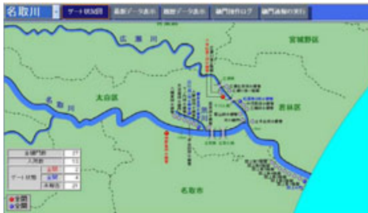
図 5.2.4 樋門樋管操作システム運用状況
