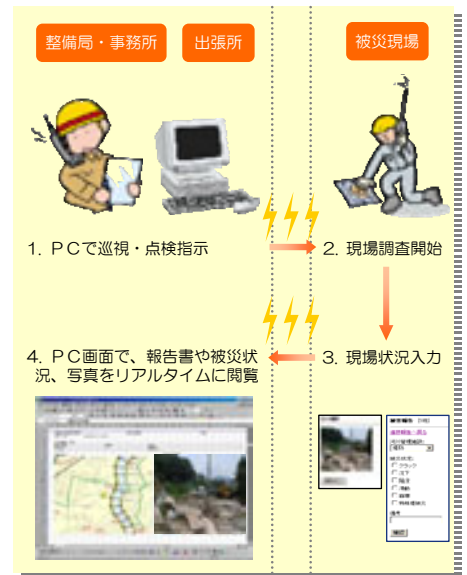
図 5.2.7 河川巡視点検システムのイメージ
