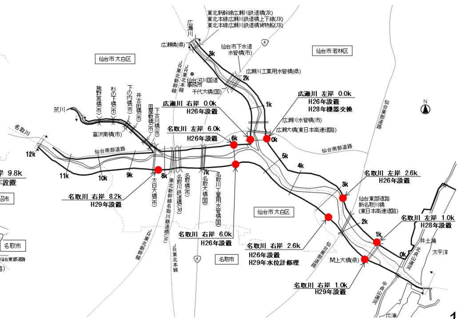
【名取川 危機管理型水位計設置状況】
