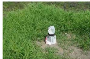
調査孔ガス採取時の状況
