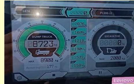
土の重量を油圧ショベルのバケットによって計測することで、オペレーターがダンプトラックへの積込量を把握できるため、最大積載量以内で積込むことが出来る。積載重量・積載可能重量はタブレットアプリのモニターでリアルタイムに確認でき、積み込み履歴についても現場事務所のパソコンやタブレット端末から確認できる。
